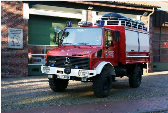
Rüstwagen Rw1 Florian Plön 11/51/01 Baujahr: 1990 Fahrgestell: Daimler Benz U1300L Aufbau: Wackenhut
